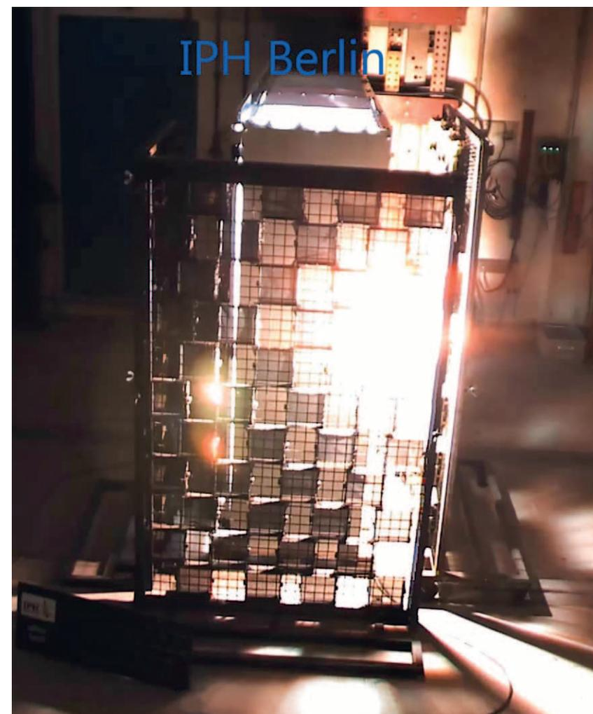
VAMOCAN-Anlage bei Prüfungen unter Störlichtbogenbedingungen
